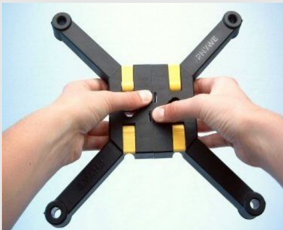
Desmontaje de la base de apoyo
